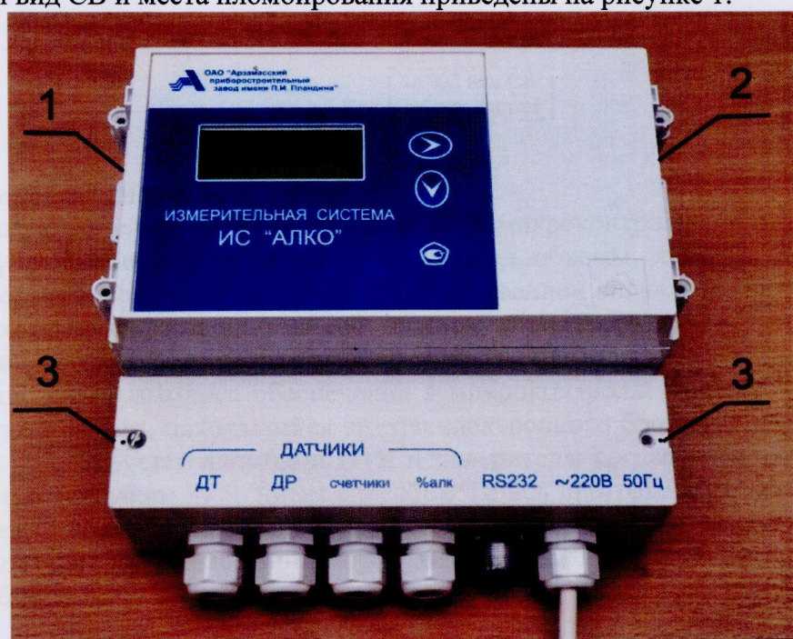
1 - пломба завода-изготовителя; 2 - знак поверки; 3 - пломбы специалиста, проводившего пуско-наладочные работы Рисунок 1
